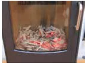
6. Legg 2 vedkubber på ca. 0,7 kg hver og med en lengde på ca. 25–30 cm over glørne i ett lag med en avstand på ca. 1 cm mellom kubbene.
